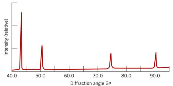
**Questão 3)** [2,0] a) Para qual conjunto de planos cristalográficos ocorrerá o pico de difração de primeira ordem em um ângulo de difração de  $46,21^\circ$  para o Fe CCC quando uma radiação monocromática com comprimento de  $0,0711\text{nm}$  é usada?
